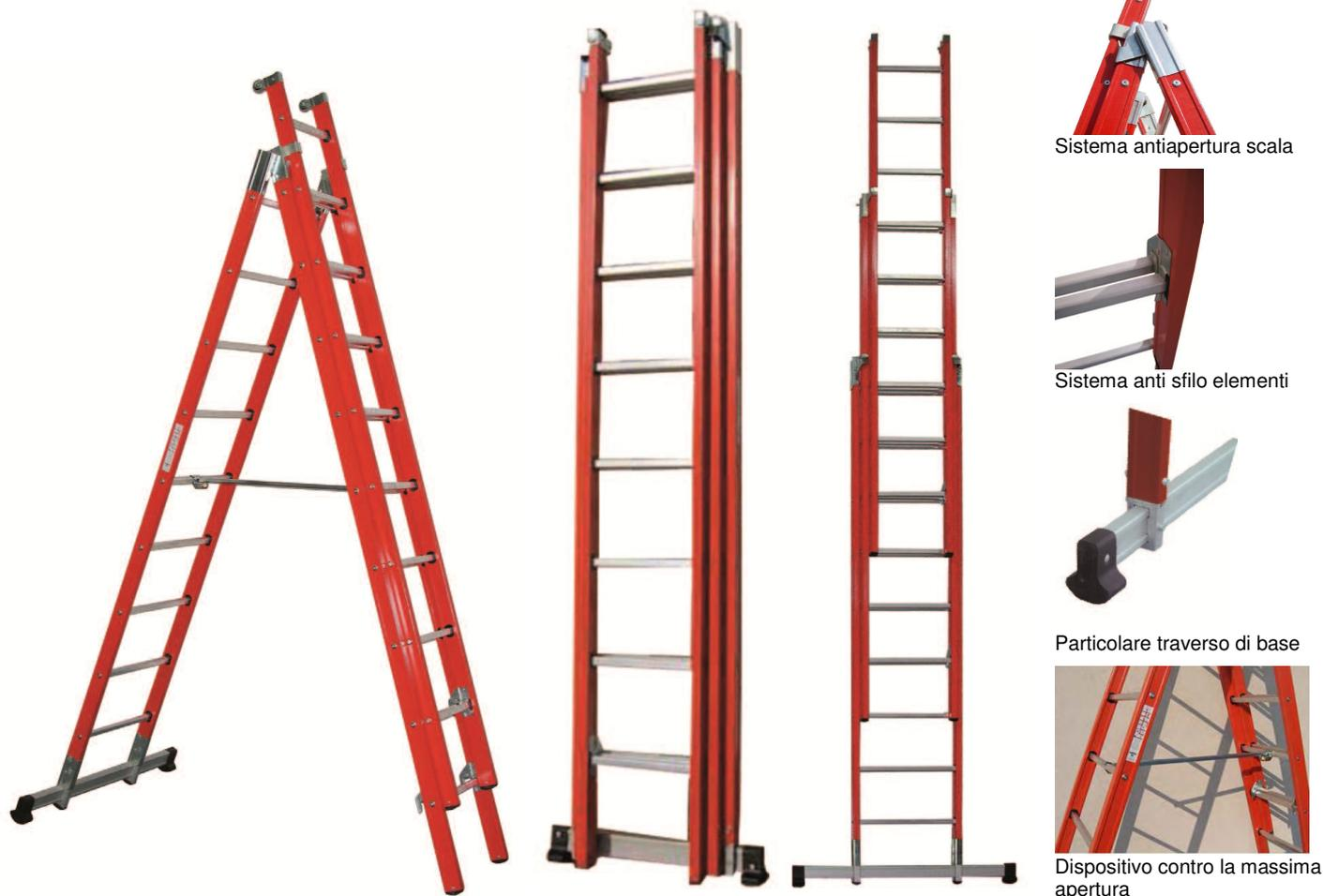
Scala a sfillo in vetroresina con gradini antiscivolo in alluminio, indicata per gli installatori elettrici; ogni elemento si sviluppa a mano, e l'operazione è facilitata dalla presenza delle rotelline di scorrimento alla sommità. Grazie al traverso di base la scala può essere utilizzata anche a cavalletto, applicando il dispositivo contro la massima apertura in dotazione alla scala.
