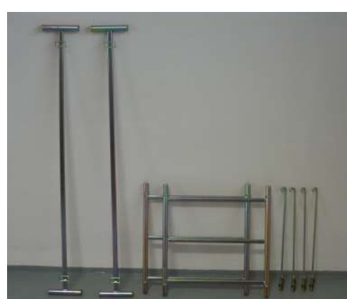
composizione del piano trabattello da mt 1,00
