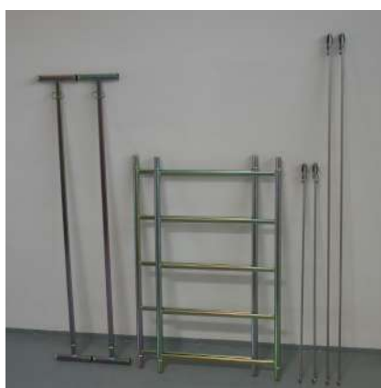
composizione del piano trabattello da mt 1,50
