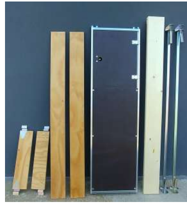
componenti del piano di lavoro
