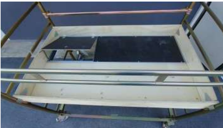
piano di lavoro a norma con tavole legno e supporto allum/resinato con botola
