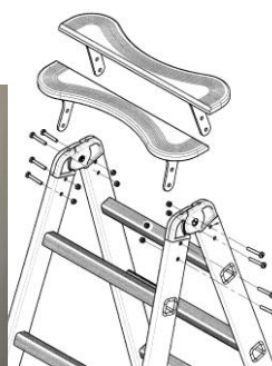
Cerniere in alluminio fuso e frizione interposta
